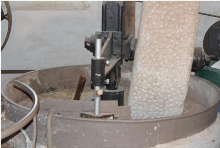
**1° étape** : Paille et chiffons, dans un bac, broyés par une meule .Bac et meule sont animés d'un mouvement en rotation inversée.
