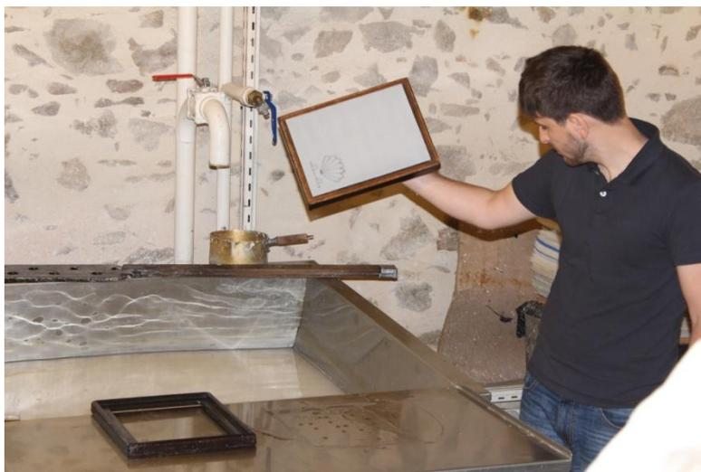
**3° étape** : Démonstration manuelle par un technicien de la fabrication d'une feuille de papier. Il plonge le cadre dans la pâte, le retire et laisse écouler le surplus d'eau. Puis il retourne le cadre (geste délicat) et la feuille est déposée sur la table pour un premier séchage.
